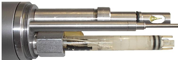
Abb.: Sonde ohne Schutzkorb mit Sensoren für Ozon, pH, Temperatur und Tiefe.
