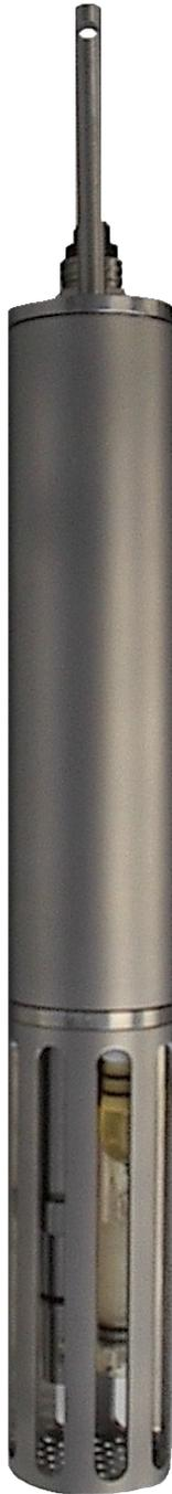
Die Bestimmung von **gelöstem Ozon** ist einer der wichtigsten Parameter bei der Überwachung in Wasserwerken, aber auch in der Industrie nach der Behandlung mit Ozon, für Swimmingpools oder in der chemischen Industrie.
